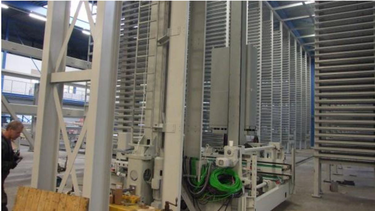
De robotgestuurde wagen wordt opgebouwd.
