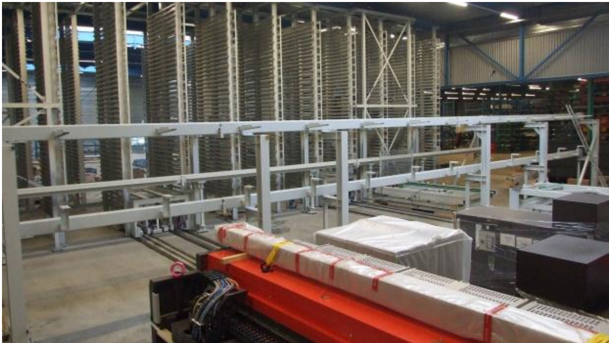
Het platenmagazijn van Kasbo bevat 930 palletplaatsen.
